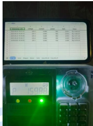
Gambar 3.6 perbandingan Tegangan Arus dan Daya pada meteran dan sensor Pzem_004T. (Syahri, 2025)
