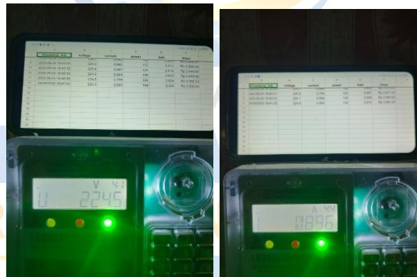
Gambar 3.5 perbandingan Tegangan Arus dan Daya pada meteran dan sensor Pzem_004T. (Syahri, 2025)
